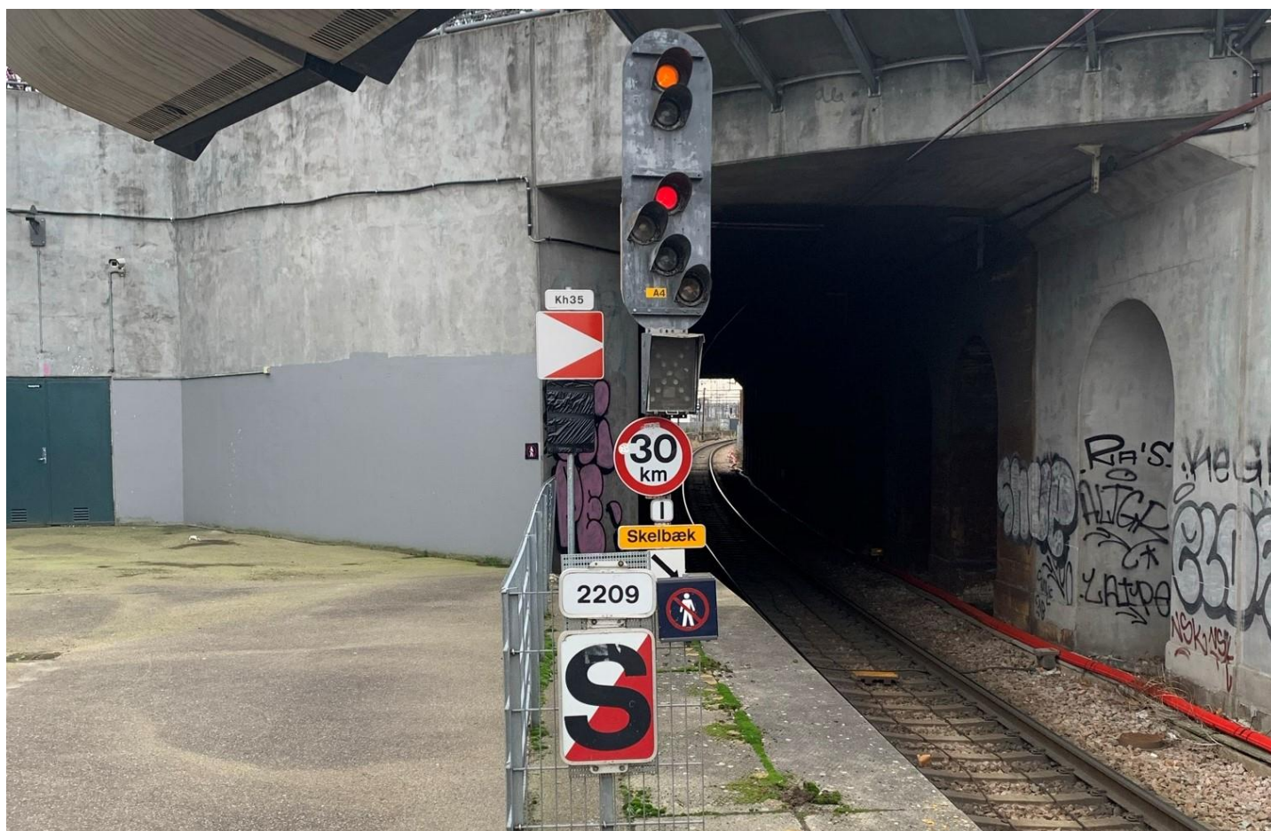
Billede 2: Dybbølsbro spor 6. Forrest ses HKT Mærke 2206, som med tiden afløses af CBTC mærke KH35. I signalet til Skelbæk forsvinder helt når CBTC indføres.
